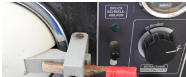
Als de apparatuur zo intensief gebruikt moet worden, treden gebreken op. Afrikaanse reparatie van de sluiting van de autoclaaf.
